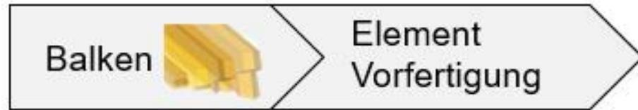
Balken, Platten, Wärmedämmung, Innenbeplankungen werden zu Elementen vormontiert
