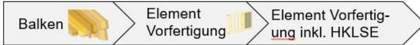
Balken, Platten, Wärmedämmung, Innenbeplankungen und HKLSE Elemente werden zu Elementen vormontiert
